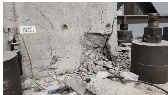
(左) 令和元年12月にEーディフェンスで加振試験を実施した試験体と研究チーム (右) 加振試験で得られた実際の損傷。多数のセンサで計測を行った。
